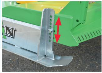
**Sistema de altura de corte ajustable en 8 posiciones**
